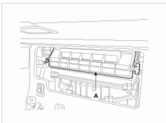
4. 确认空气滤清器的安装方向，安装空气滤清器（B）。
